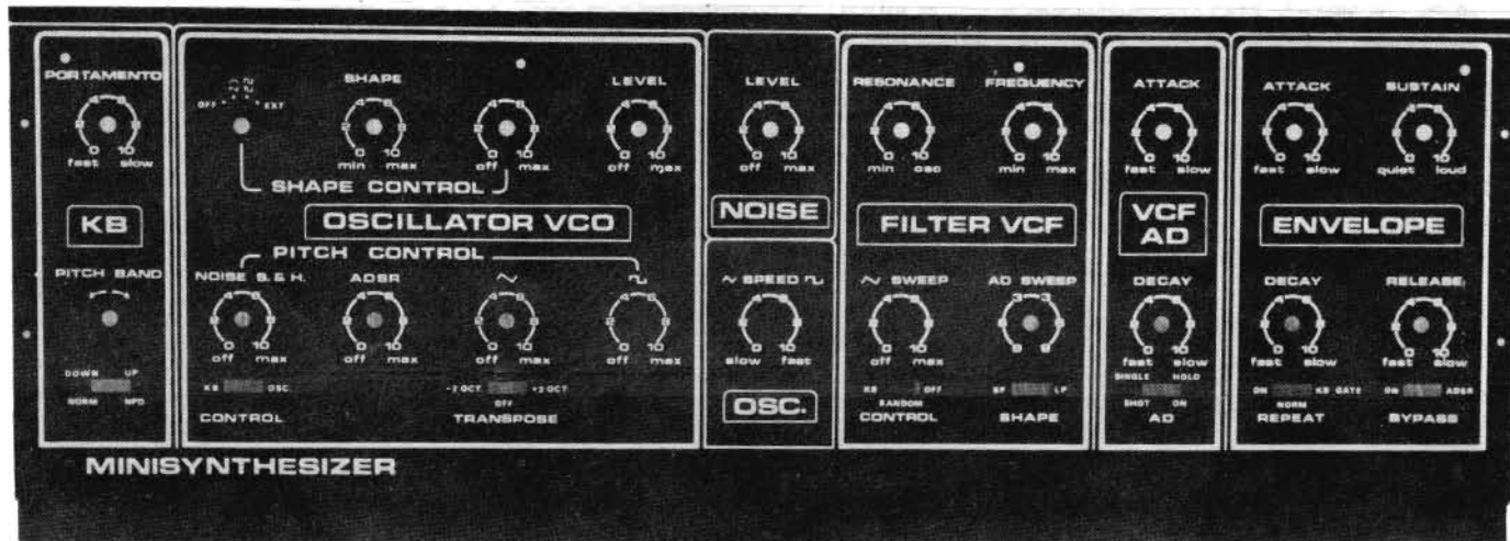
Foto 2 - Riproduzione fotografica del pannello frontale del mini sintetizzatore che stiamo descrivendo. Sotto si è voluto riportare il disegno per mettere in condizione chi lo desiderasse, di riprodurselo. Attenzione però, che le misure reali sono 570 x 160. Tuttavia per chi non volesse tanto tribulare può richiedere copia del disegno originale al Servizio Assistenza Lettori; questo dicasi anche per il circuito stampato riportato sulle pagine seguenti.
